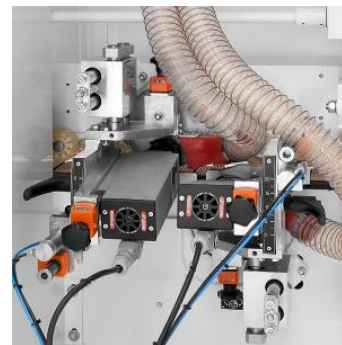
Pozitionare automata, pneumatica sau electrica, a grupului de frezare
