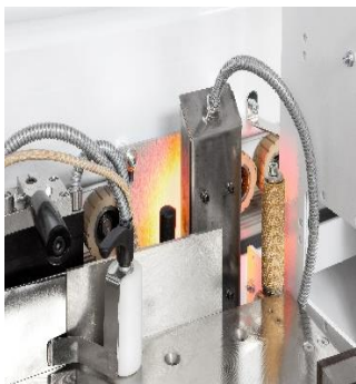
Lampa cu infra – rosu pentru incalzirea laturilor panoului
