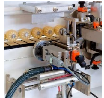
Unitate pentru rotunjire la capete cu un motor.
