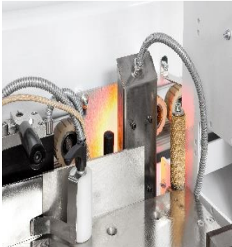
Lampa cu infra – rosu pentru incalzirea laturilor panoului
