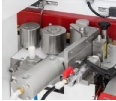
Grup de presare cu 2 role. Rola principala motorizata.
