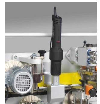
Pneon cu jet de aer cald pentru canturile inchise la culoare, matuite.
