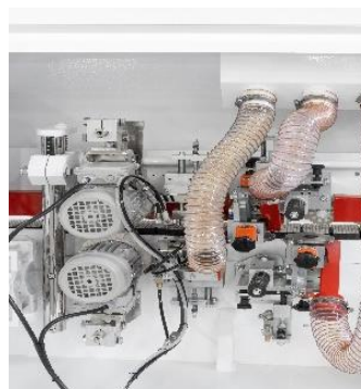
Activare / dezactivare pneumatica a grupurilor de finisare
