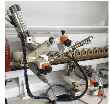
Unitate pentru rotunjire la capete cu doua motoare.
