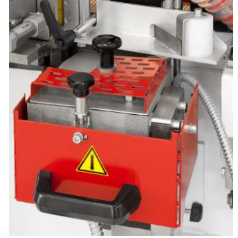
Vas de adeziv teflonat cu dispozitiv de drenaj.
