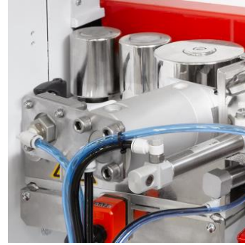
Grup de presare cu 3 role. Rola principala motorizata.
