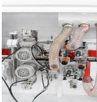
Activare / dezactivare pneumatica a grupurilor de finisare
