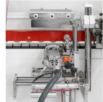
Unitate pentru rotunjire la capete cu un motor.
