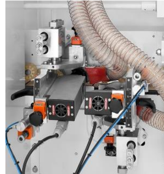
Pozitionare automata, pneumatica sau electrica a grupului de frezare
