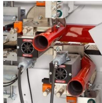
Unitate de frezare cu copiatori circulari.
