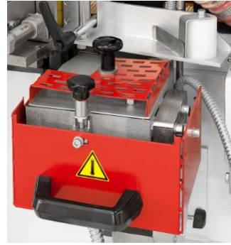
Vas de adeziv teflonat cu dispozitiv de drenaj.
